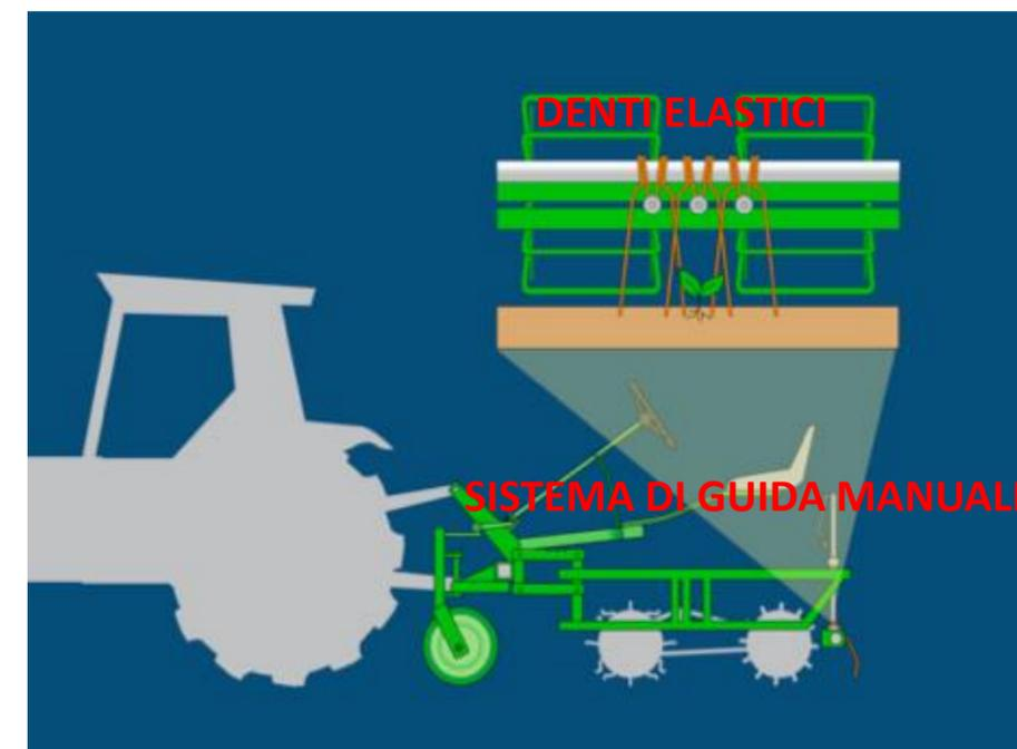
Fig.4 - Conformazione dell'ultima versione dell'erpice a dischi attivi, equipaggiata con un sistema di guida manuale e con tre coppie di denti elastici e quindi in grado di operare come sarchiatrice di precisione sia nell'inter-fila che sulla fila.
